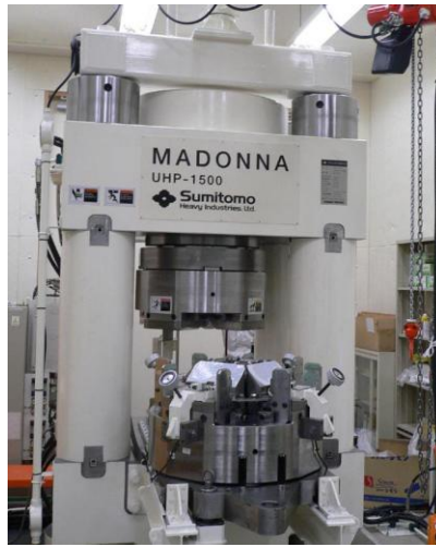
世界最大を含む、GRCの世界最多の大型超高压実験装置群
