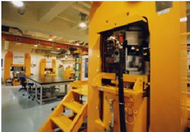
世界最大を含む、GRCの世界最多の大型超高压実験装置群
